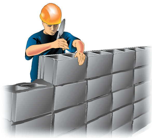
Posa a giunti verticali allineati (a sorella)
