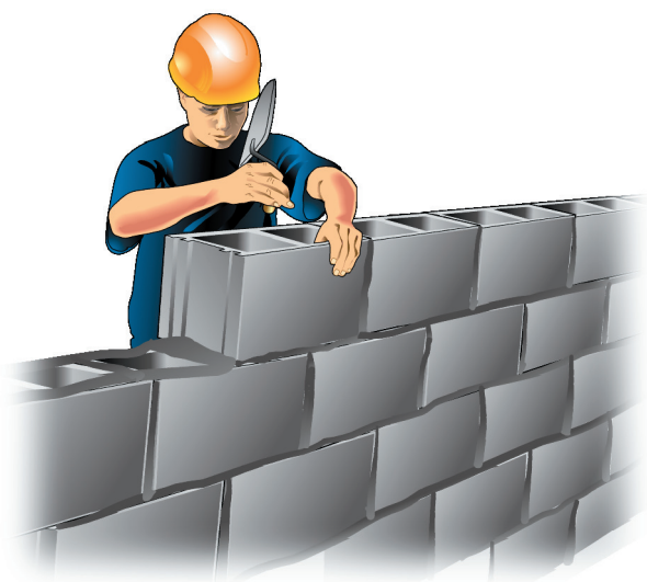
Posa a giunti verticali sfalsati
